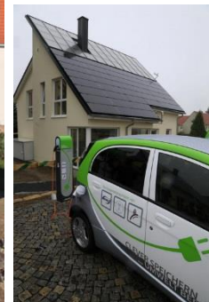
Abbildung 4: Intelligente Eigenversorgung mit Wärme, Strom und Mobilität aus der Sonne. Das Haus wird zur Tankstelle. Es hat eine Wohnfläche von 161 m 2 , Solarthermie 46 m 2 mit 9 m 3 Langzeitwärmespeicher, 8,4 KWP Photovoltaik mit 58 kWh Akku. Die ersten beiden bewohnten energieautarken Einfamilienhäuser Europas in Freiberg/Sachsen, errichtet von der HELMA Eigenheimbau AG Baujahr 2013. Drei Jahre lang werden diese beiden Häuser durch die TU Bergakademie Freiberg messtechnisch untersucht. Primärenergiebedarf: 7 kWh/m 2 a, Stromverbrauch 2.100 kWh/a, Holzbedarf 2-3 rm/a.
