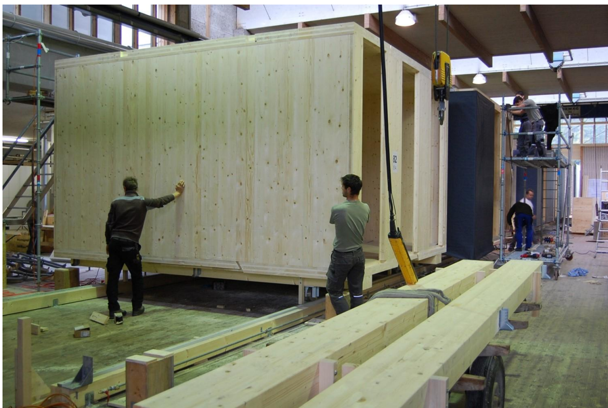
Abbildung 1: Vorfertigung von Raumzellen in einer Zimmerei
